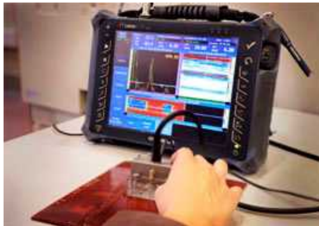
Figura 9 Equipo para detectar rajaduras
